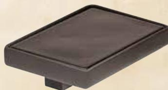
Die Aufkittschale ist mit einem speziellen Fasserkitt gefüllt, welcher beim Erhitzen weich wird. Kleine, zerbrechliche oder unregelmässig geformte Stücke können so problemlos zum Gravieren, Fassen von Steinen und zur anderweitigen Bearbeitung gehalten werden. Passend zu allen Schraubstöcken oder Gravierkugeln.
