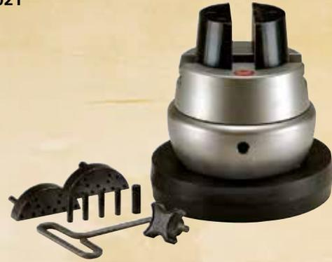
Diese schwere Gravierkugel bietet zusätzliche Stabilität beim Einsatz von größeren Werkzeugen, Ziselierhämmern und Ähnlichem. Ein massives Kugel- und Rollenlagersystem ermöglicht sanfte Drehungen ohne Verschleiss oder Spiel. Mit Hilfe des internen Dreh-Bremssystems kann der Drehwiderstand leicht eingestellt werden. Hergestellt aus solidem Edelstahl mit Satinoberfläche. Schwarze Klemmbacken verringern Blendeffekte und Augenbelastung.
