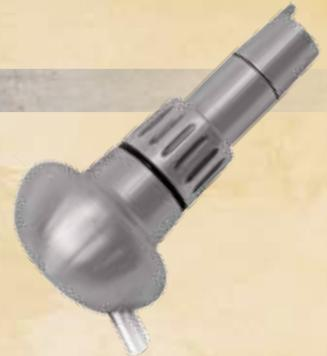
Dies ist das präziseste Handstück zur sicheren Ausführung ultrafeiner Fasserarbeiten und Gravuren, insbesondere im Bulino- und Banknotenstil. Das Monarch-Handstück ist ausgeführt mit eloxiertem Aluminium-Knauf und Spannkolben in wärmebehandelter Edelstahlkonstruktion mit Einstellbarkeit der Seitenschlauchverbindung. Einschliesslich 6 QC-Werkzeughalter.
