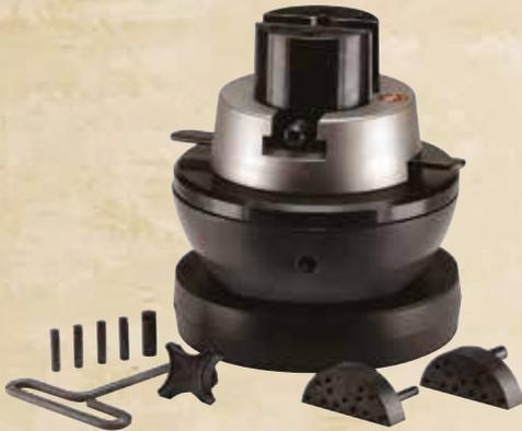
Die Gravierkugel Spezial von GRS ist dem MagnaBlock ähnlich, weist aber einen einzigartigen Unterschied auf: einen positionierbaren Drehungsmittelpunkt. Bei Arbeiten unter dem Mikroskop ist dies eine wichtige Funktion, damit das Arbeitsstück im Sichtfeldzentrum gehalten werden kann. Dieses Detail spart viel Zeit beim Arbeiten. Bei dieser grössten von GRS hergestellten Gravierkugel bietet das zusätzliche Gewicht und eine grössere Basis grösstmögliche Stabilität und Einstellbarkeit.
