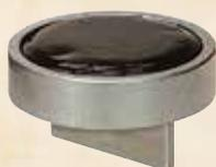
Die Aufkittschale ist mit einem speziellen Fasserkitt gefüllt, welcher beim Erhitzen weich wird. Kleine, zerbrechliche oder unregelmässig geformte Stücke können so problemlos zum Gravieren, Fassen von Steinen und zur anderweitigen Bearbeitung gehalten werden. Passend zu allen Schraubstöcken, Gravierkugeln oder BenchMate-Systemen.
