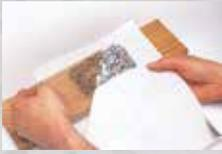
Fotokopieren Sie ein Design auf diese selbstklebende Plastikfolie (216 × 279 mm) und kleben Sie diese auf Ihr Werkstück. Gravieren Sie danach den Linien entlang direkt durch die Folie.
