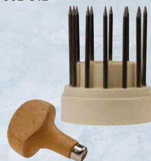
Gehärtete Korneisen mit präzise geformten, konkaven Spitzen zum Formen von Körnern beim Steinfassen oder Gravieren. Der Satz enthält zwölf Korneisen: Grössen: 2, 4 und 6 – 16. Inkl. Heft. Das Werkzeug #16 erzeugt ein Korn oder Punkt von 1 mm. Die Werkzeuggrössen steigen jeweils um 0,05 mm.
